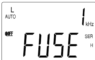
Figura 7.- Detección del estado del fusible
